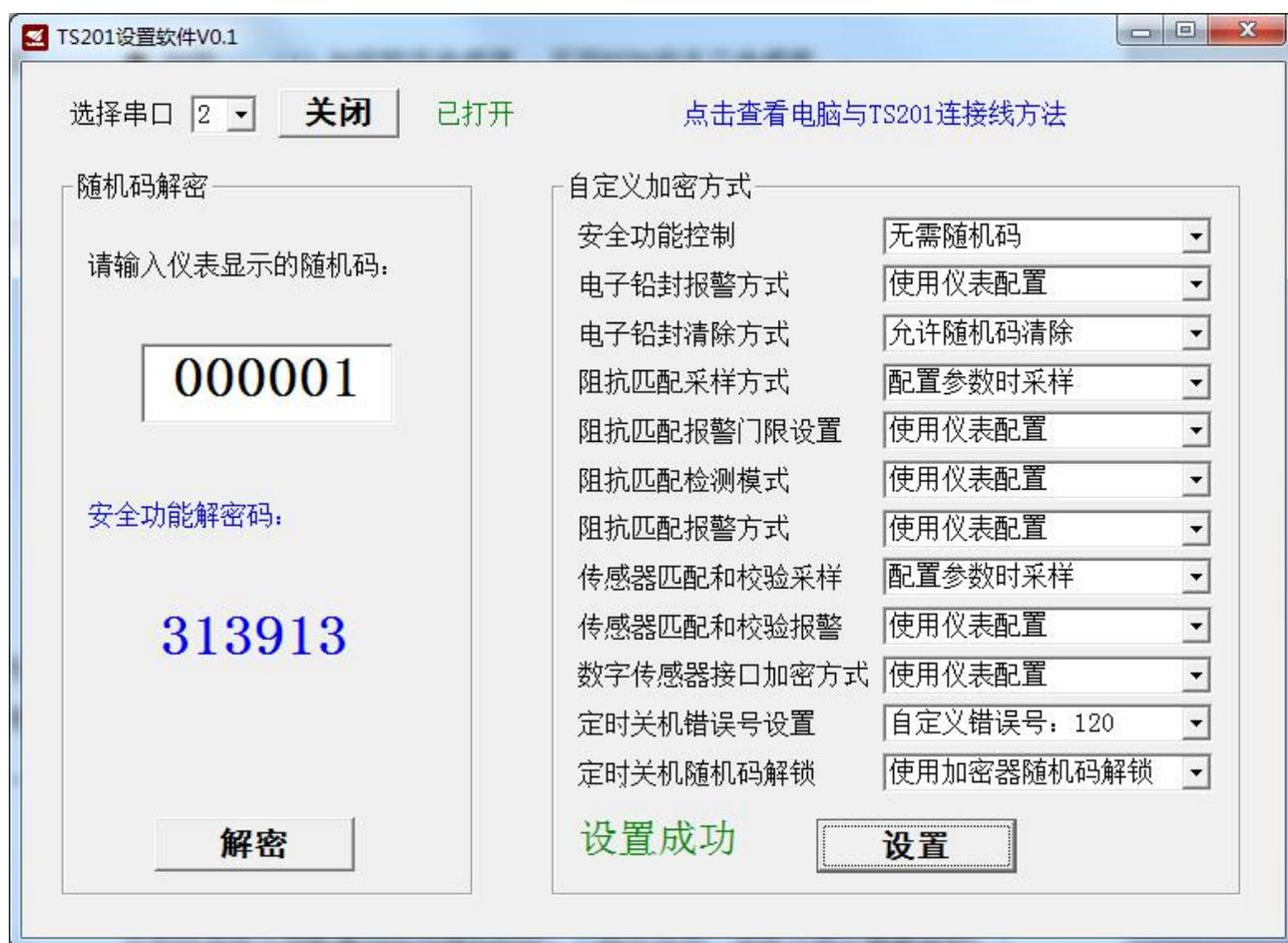
使用电脑通讯连接线，连接电脑与加密器，选择对应串口，点击“打开”，开始后续操作。
